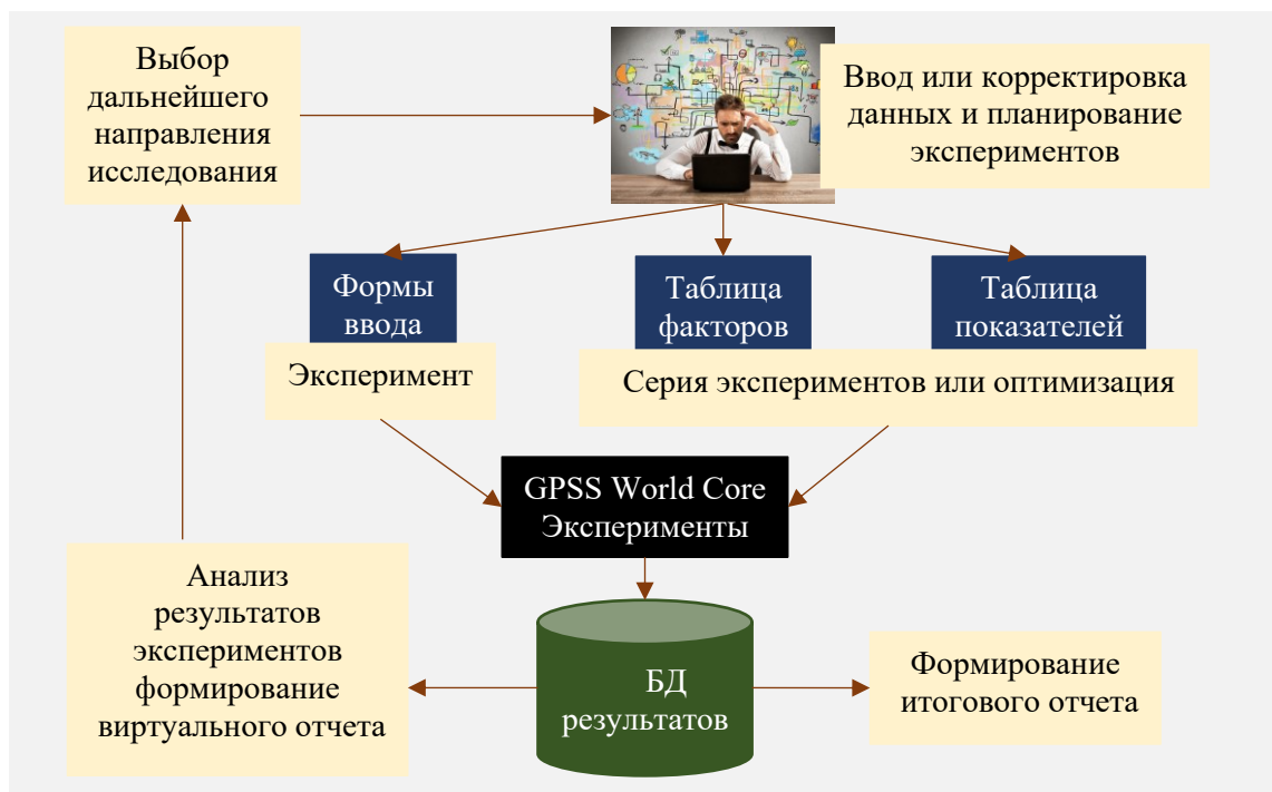
Рисунок 6: Схема проведения имитационного исследования в GPSS Studio
