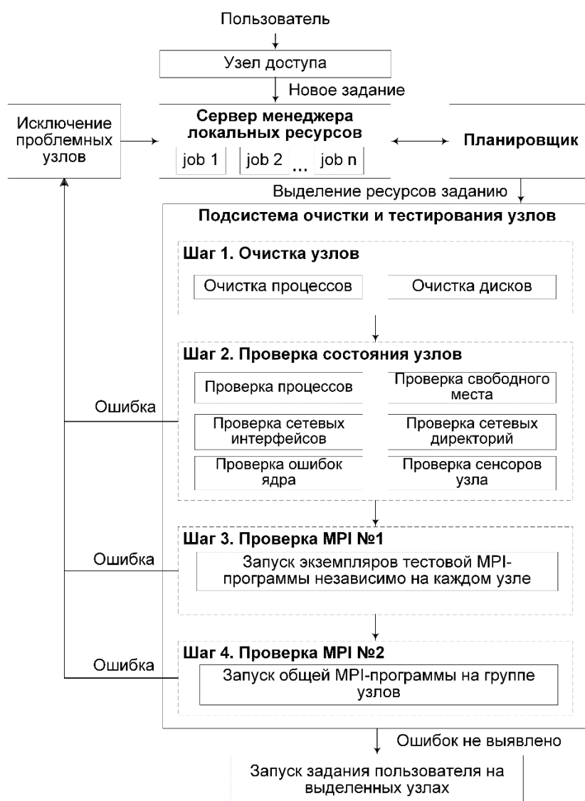
Рисунок 2: Схема тестирования узлов и освобождения их ресурсов
