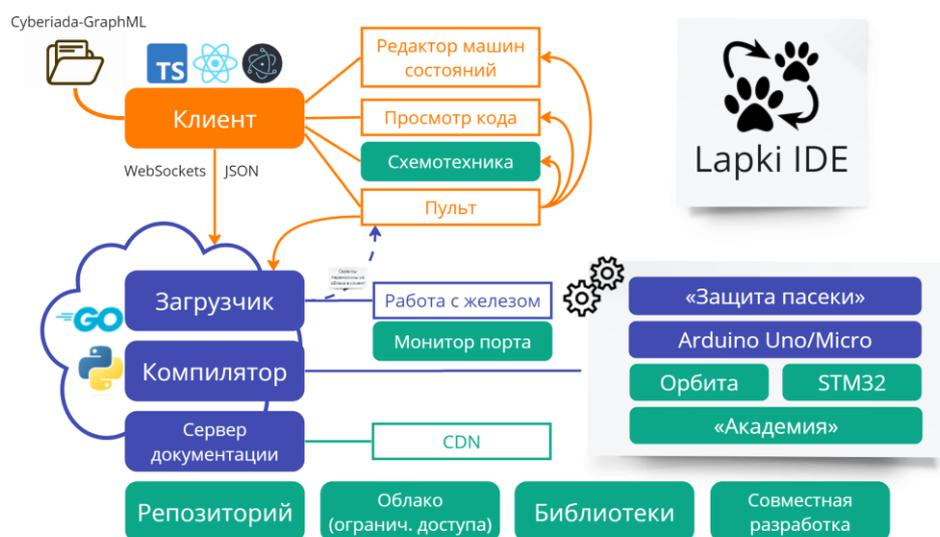
**Рисунок 1:** Схема-план архитектуры Lapki IDE
