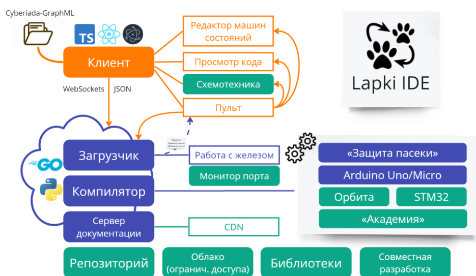
Рисунок 1: Схема-план архитектуры Lapki IDE
